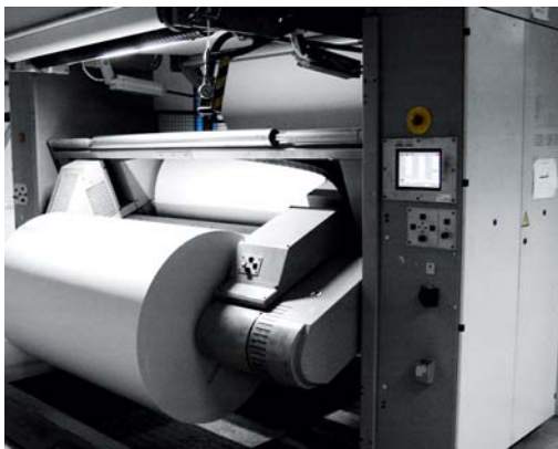
Slika 19: Izmjena role papira a novinskoj ofset rotaciji
