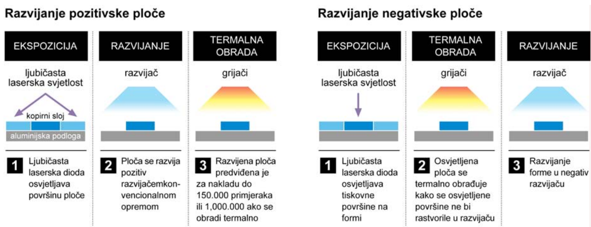
Slika 59: Razvijanje pozitivne i negativne tiskovne ploče
