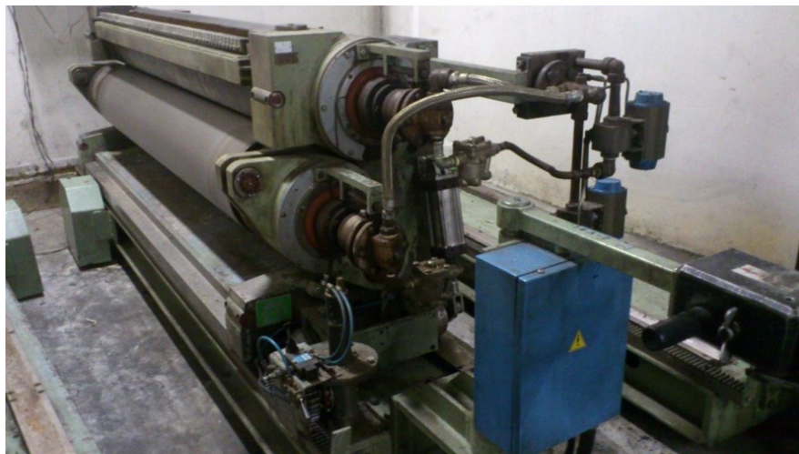
Slika 10. Rebrasti valjci koji služe za izradu valovitog sloja
