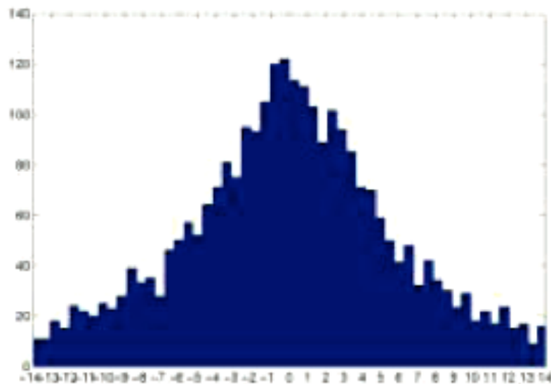
Slika 22: Distribucija AC koeficijenta za sve blokove piksela prije kvantizacije
