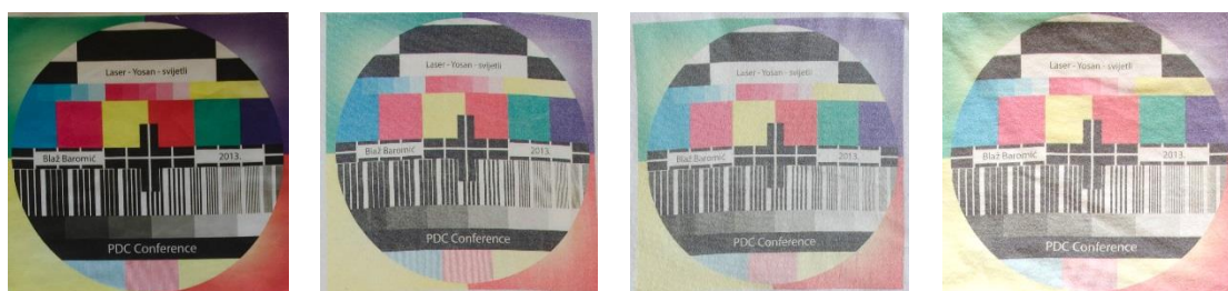
Slika 52 Laserski tisak na bijelim majicama Laser – Yosan - 60°C (neoprano, prvo, drugo i treće pranje)
