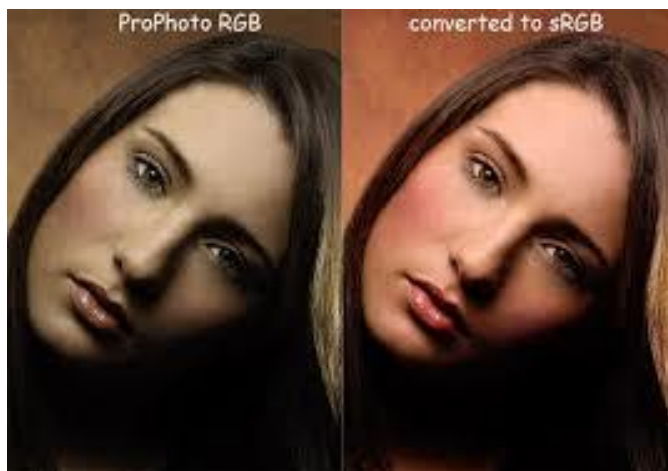
Slika 7. Fotografija snimljena u ProPhoto RGB prostoru boja i prikazana na sRGB monitoru
