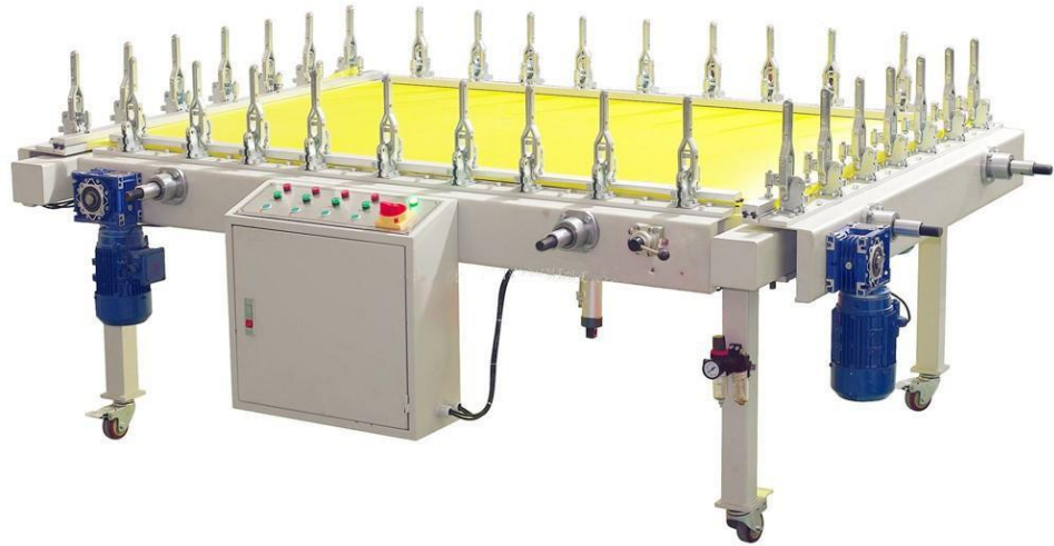
Slika 4. Uređaj za pneumatsko napinjanje sita [5] (Izvor: http://www.chinabestprice.com )
