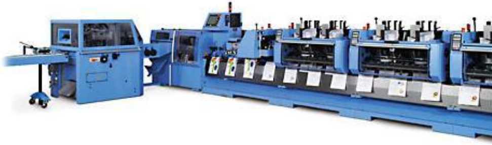
Slika 5. Stroj za meki uvez šivan žicom - Pancer linija [12]
