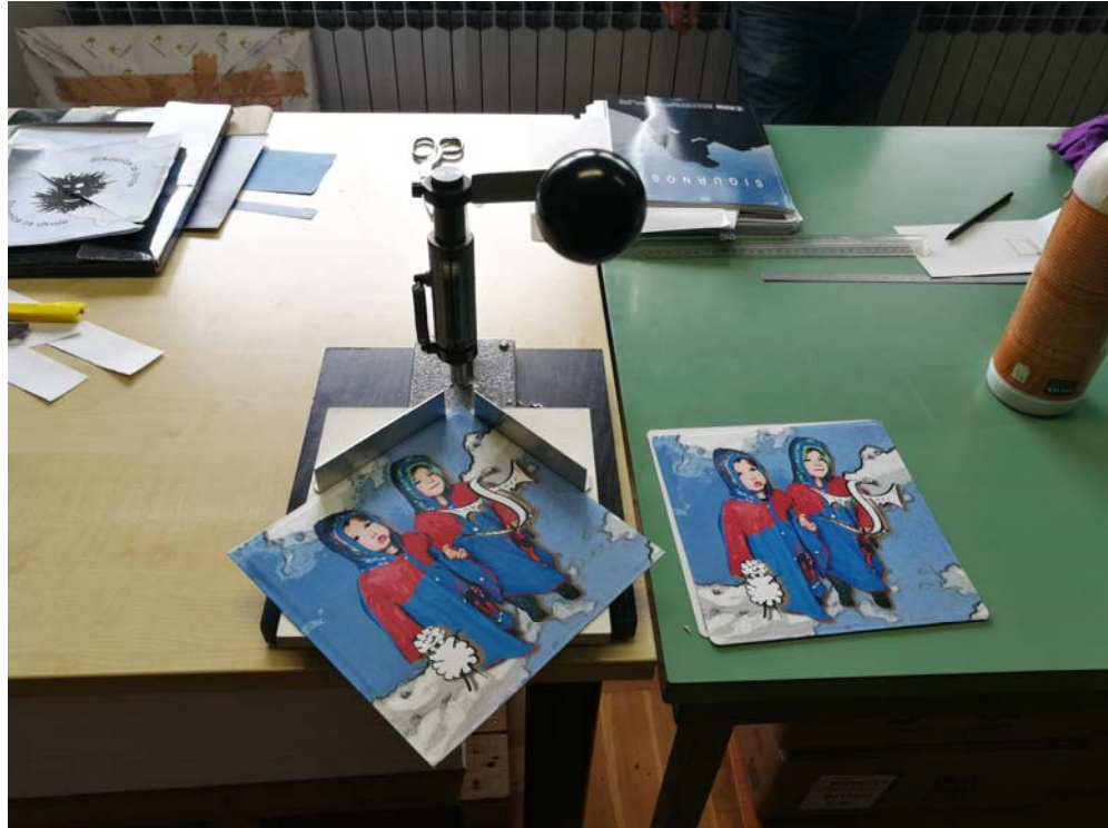
Slika 13: Obrada rubova slikovnice
