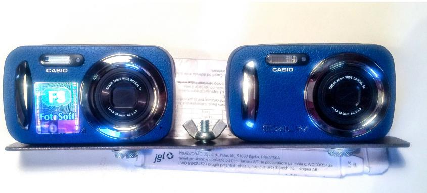
*Slika 14. Konstruirana ZRGB kamera sa metalnom pločicom*
