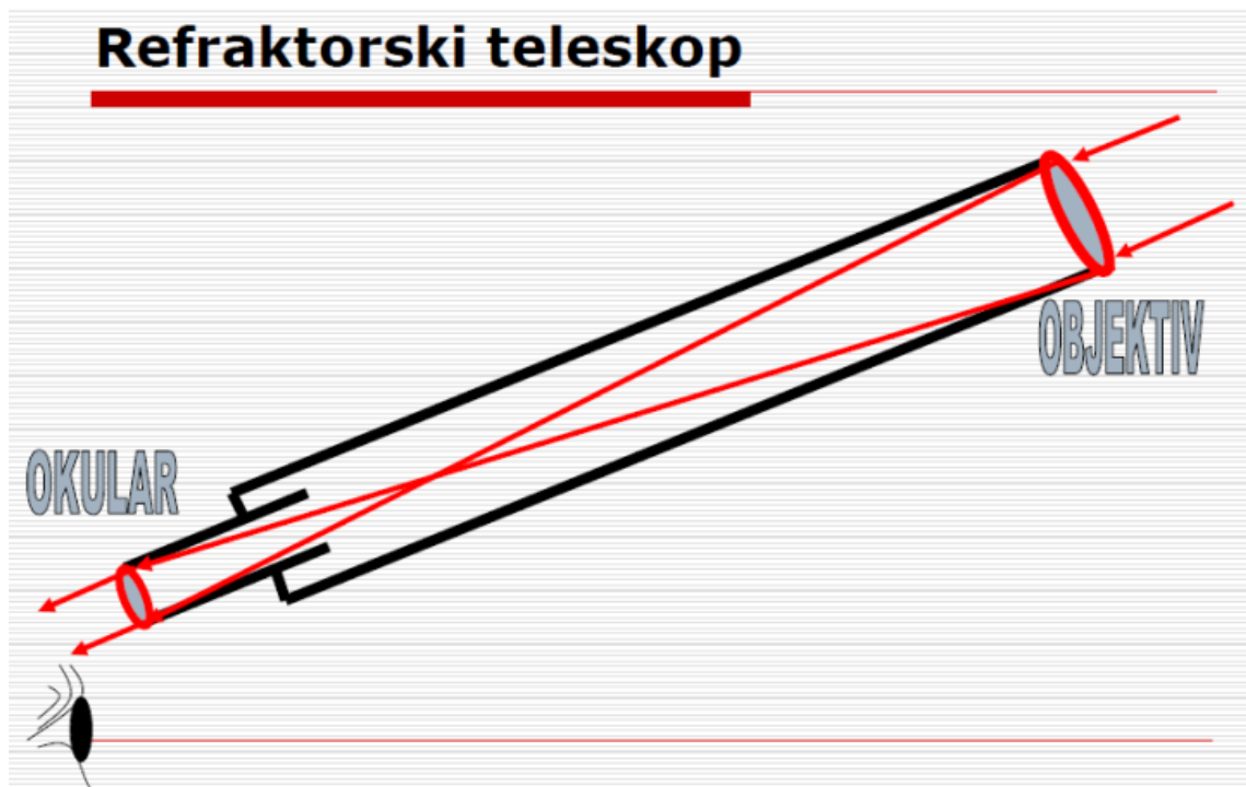
Slika 5: Princip rada refraktorskog teleskopa Izvor: https://www.emaze.com/@AWQWFTRF/Untitled
