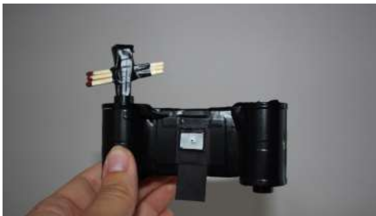
Slika 22. Gotova camera obscura
