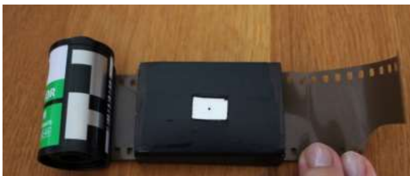
Slika 15. Postavljanje filma u cameru obscuru
