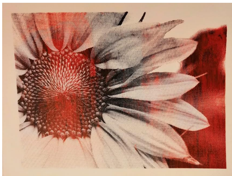
Slika 21. Otisak s dvije boje (crna i crvena) – prvi prolaz rakelom
