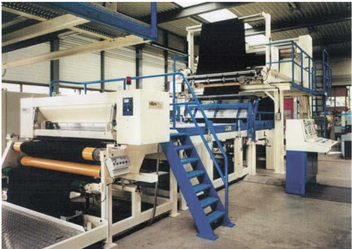
Slika 3 – Postrojenje za premazivanje ekstruzijom.
