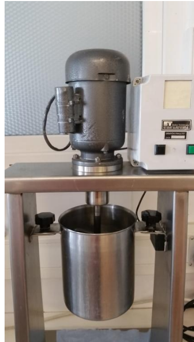
Slika 1: Uređaj za dezintegraciju [8]
