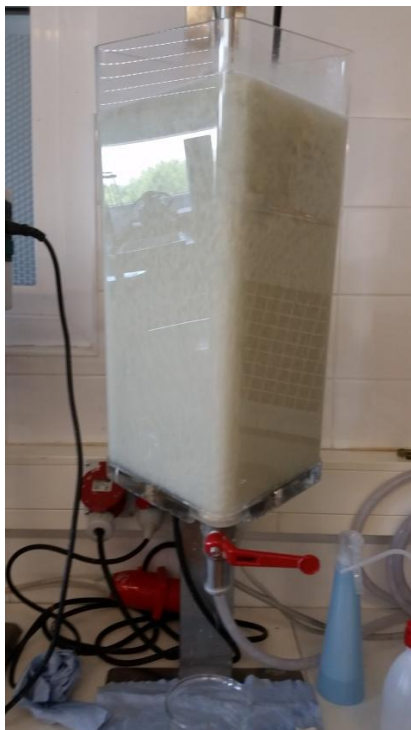
Slika 2: Uređaj za Homogenizaciju [8]
