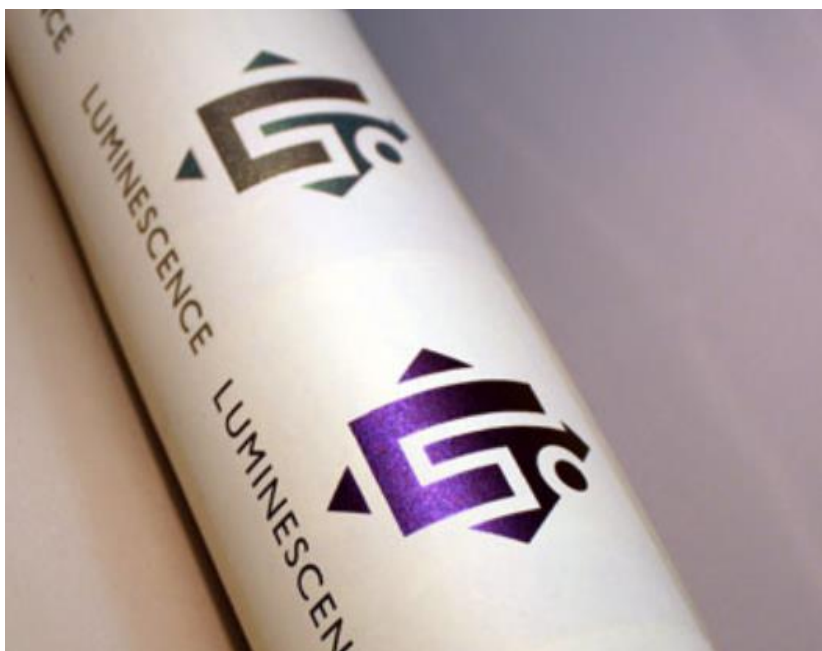
Slika 11: Optički varijabilna tinta
