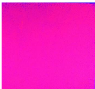
Slika 52. Otisak UV luminiscentne crvene boje na mat premazanom papiru (3 g pigmenta + 50 g baze)
