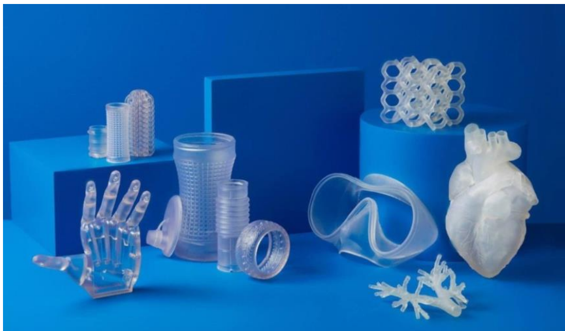
Slika 2. Objekti ispisani SLA 3D tehnologijom za upotrebu u medicinske svrhe
