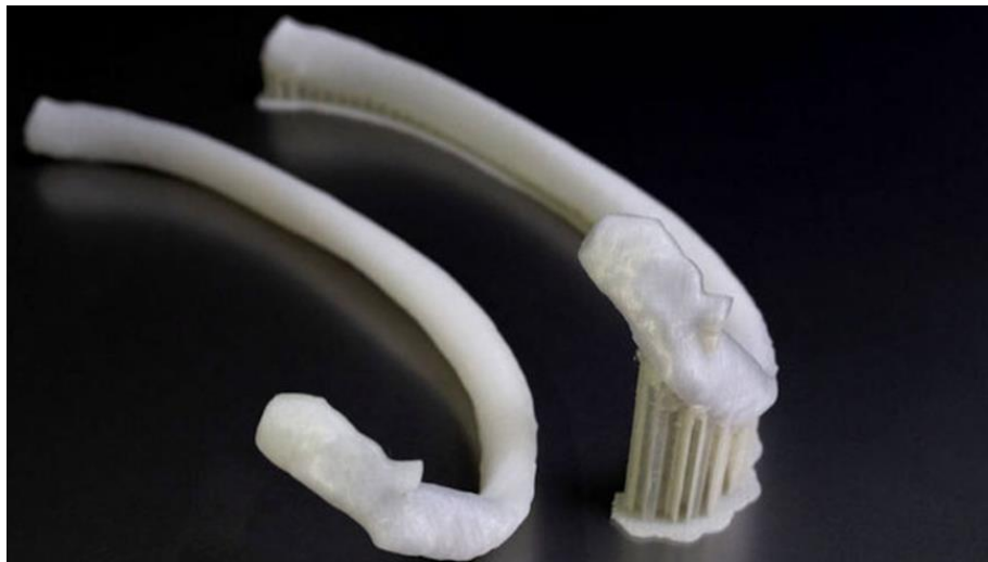
Slika 17. Prvi 3D tiskani implantat rebra od fleksibilnog poliamida
