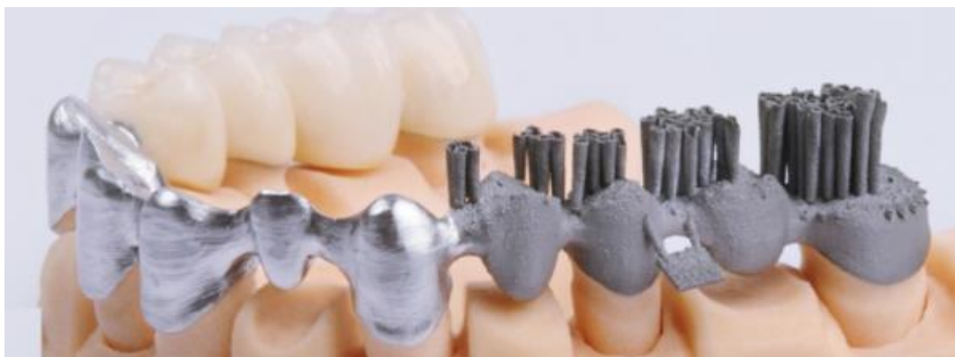
Slika 3. Dentalni implantati nastali DMLS 3D ispisom
