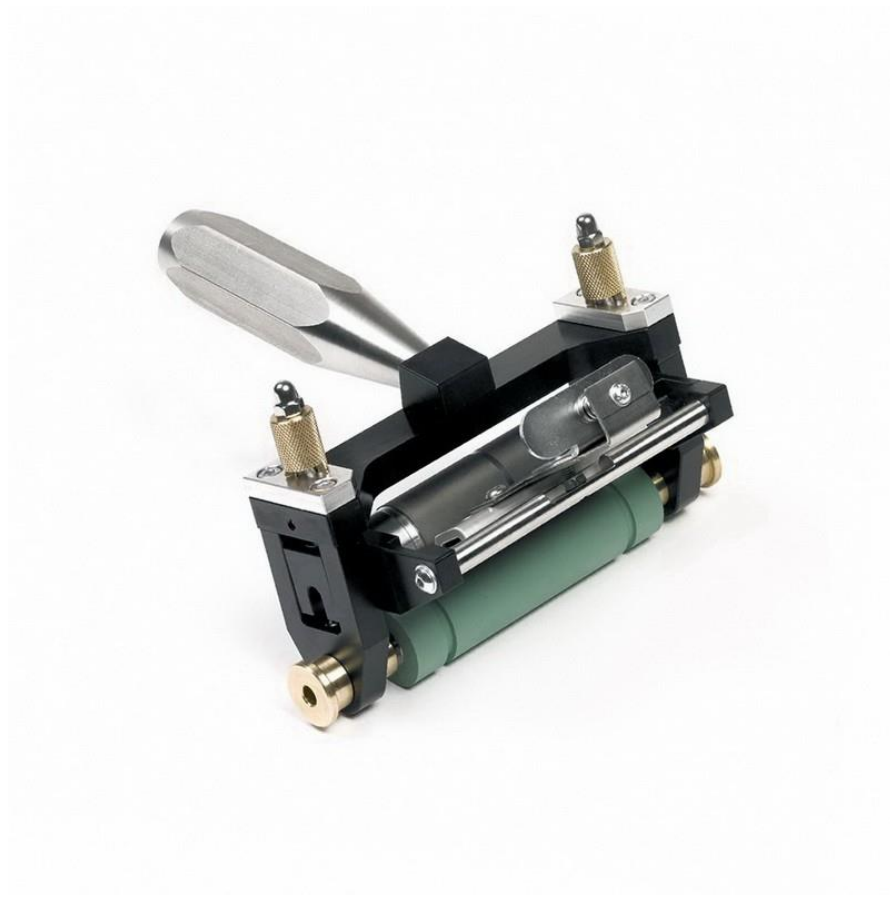
Slika 8: Esiproof uređaj za simulaciju fleksografskog tiska [19]
