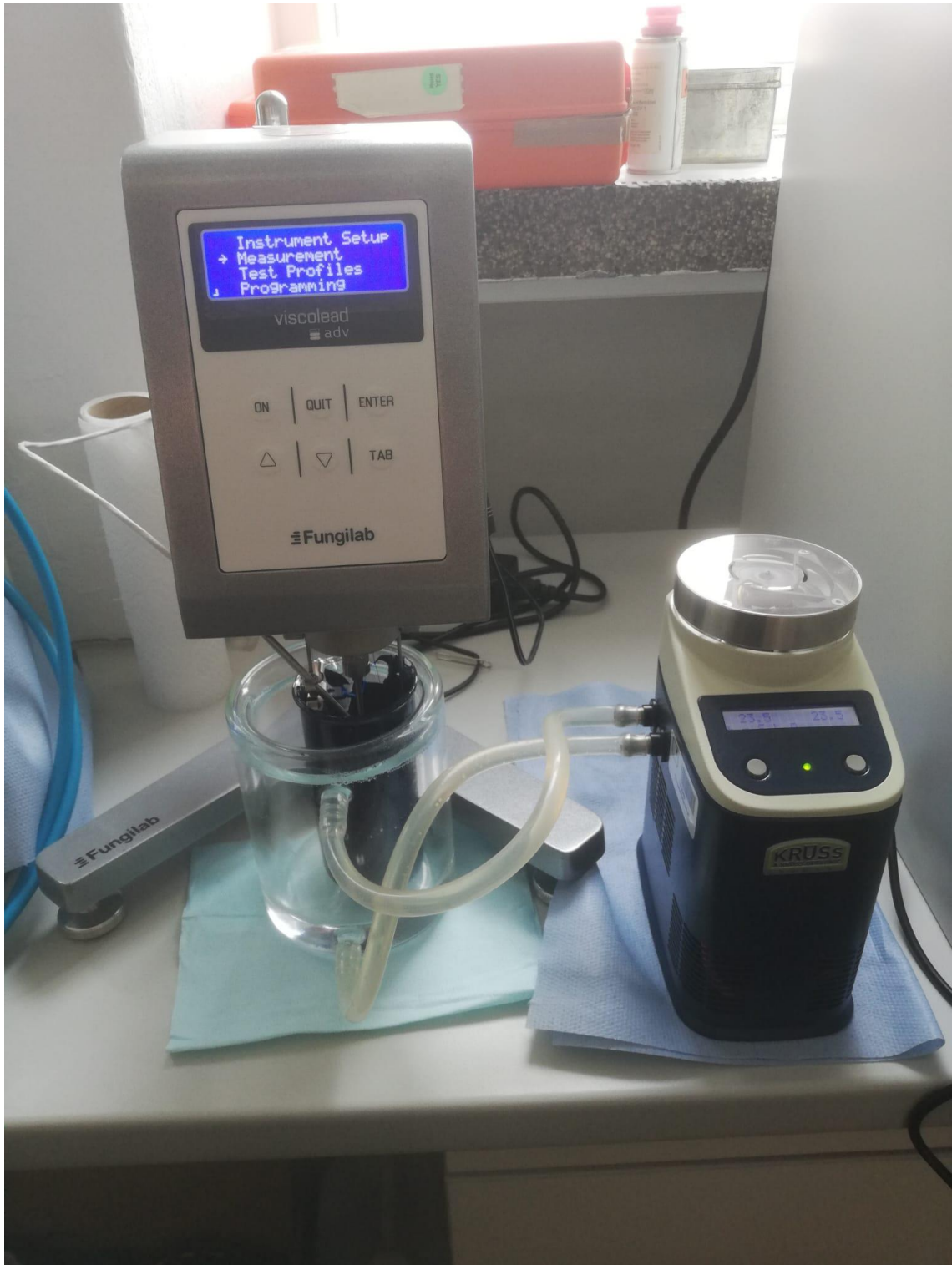
Slika 7. Rotacijski viskozimetar Fungilab
