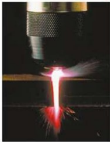
Slika 5. Zavarivanje plazmenim lukom
