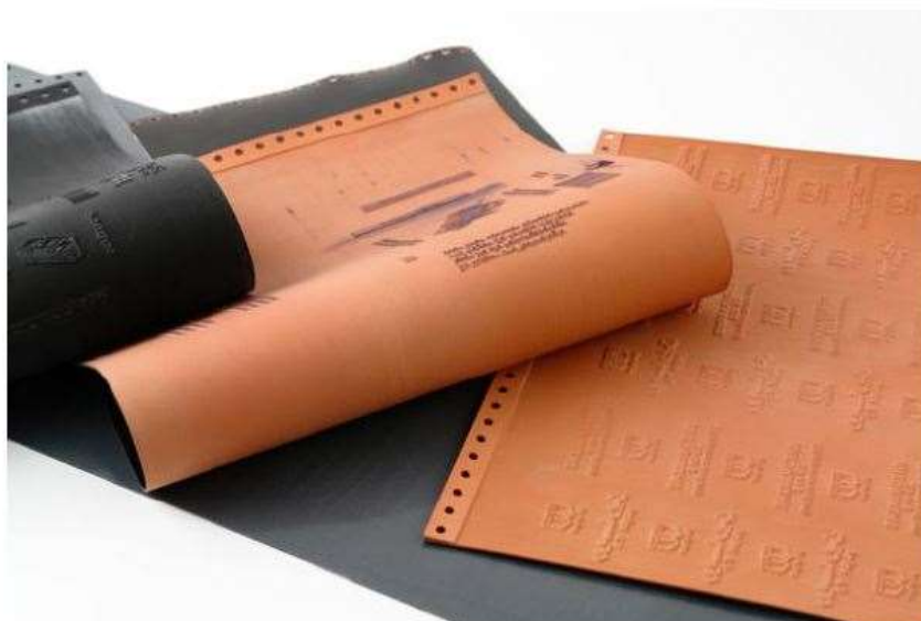
Slika 5 Gumena tiskovna forma [8]
