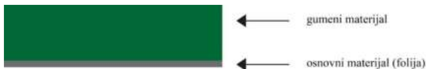
Slika 13 Jednoslojna tiskovna forma
