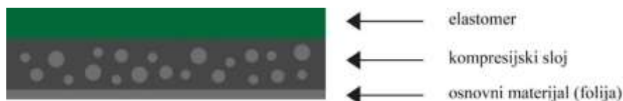
Slika 14 Višeslojna tiskovna forma
