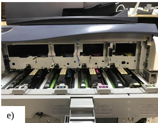
Slika 18. Postupak promjene seta tonera: a) početni CMYK set; b) CMY set nakon izvlačenja fotokonduktora; c) u fotokonduktoru nakon vađenja iz mašine; d) novi ubačen set sa fluorescentnim razvijačima i fotokonduktorima; e) stroj u fazi sa izvučenim CMY tonerima; f) ubacivanje kućišta novog seta tonera
