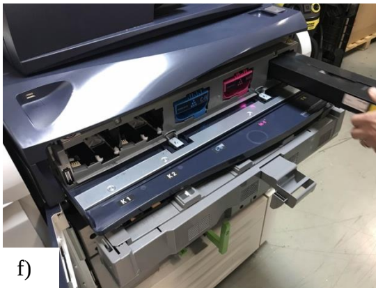
Slika 18. Postupak promjene seta tonera: a) početni CMYK set; b) CMY set nakon izvlačenja fotokonduktora; c) u fotokonduktoru nakon vađenja iz mašine; d) novi ubačen set sa fluorescentnim razvijačima i fotokonduktorima; e) stroj u fazi sa izvučenim CMY tonerima; f) ubacivanje kućišta novog seta tonera
