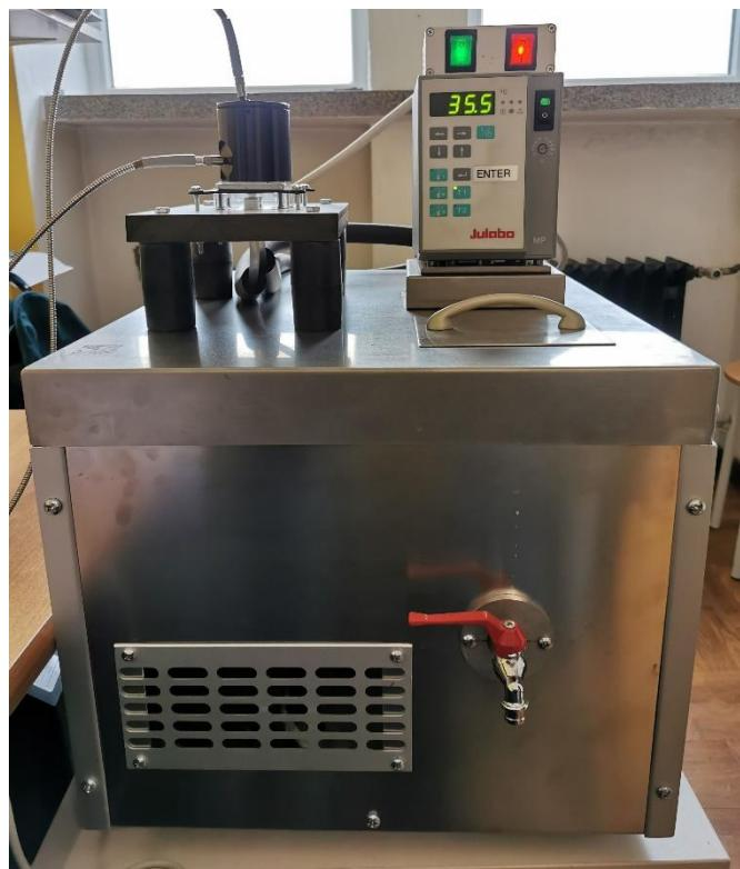
Slika 11. Uređaj za zagrijavanje/hlađenje uzorka
