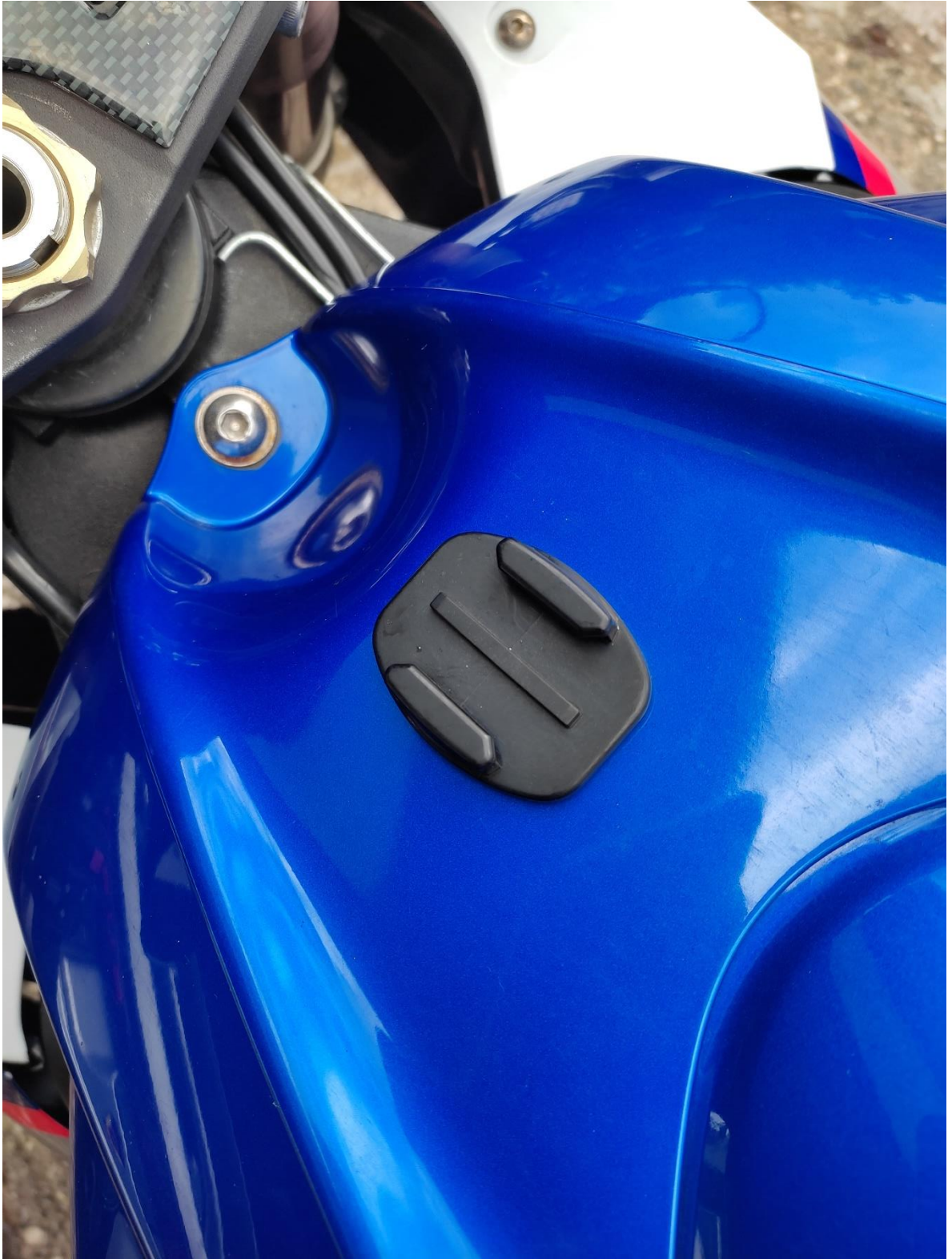
Slika 8- GoPro nastavak za montiranje kamere na rezervoar
