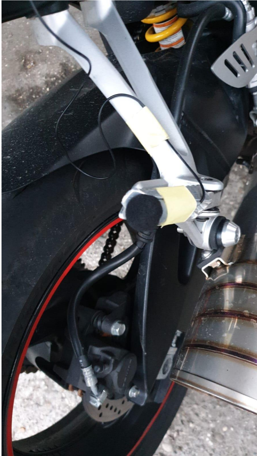
Slika 11 - Improvizirano montiranje mikroфона
