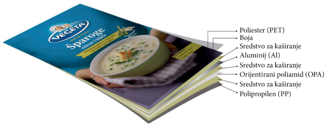
Slika 2.5. Višeslojni fleksibilni ambalažni materijal korišten u istraživanju
