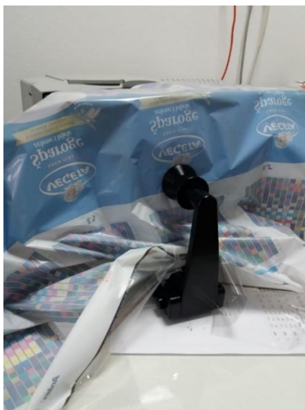
Slika 6.16. Mjerenje otiska na uređaju ColorQuest XE
