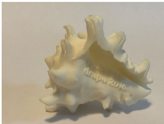
Slika 13 Replika fosila napravljena od polimernog materijala postupkom spajanja praškastih materijala
