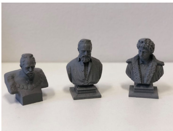
Slika 8 Replike kipova proizvedene FFF postupkom izrade
