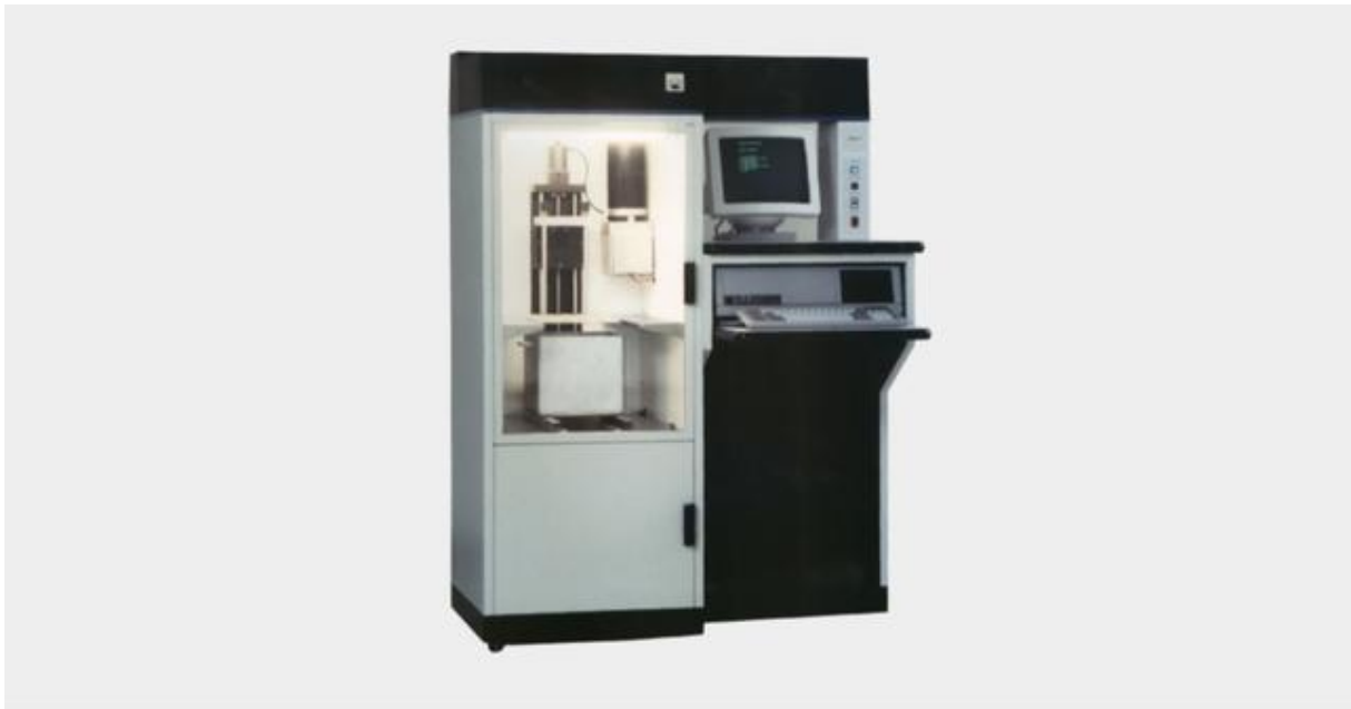
Slika 14 Prvi komercijalni uređaj za stereolitografsku aditivnu proizvodnju - SLA-1 [38]
