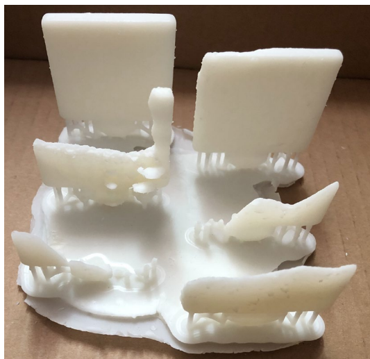
Slika 32 Ispitni uzorci degradiranih mehaničkih svojstava
