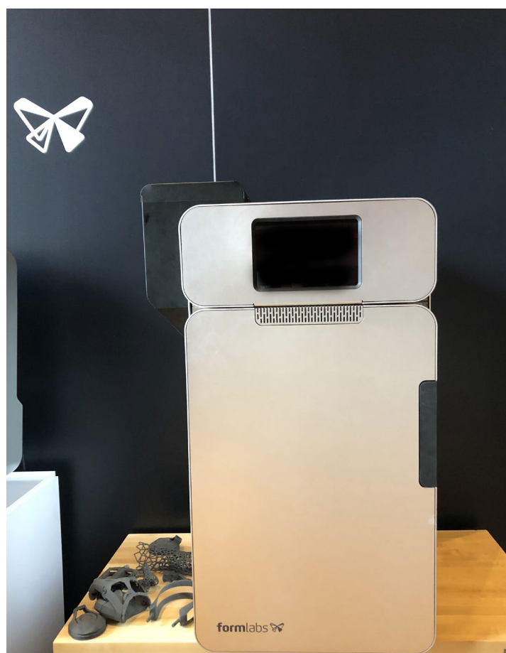
Slika 12 Uređaj za aditivnu proizvodnju postupkom spajanja praškastog materijala
