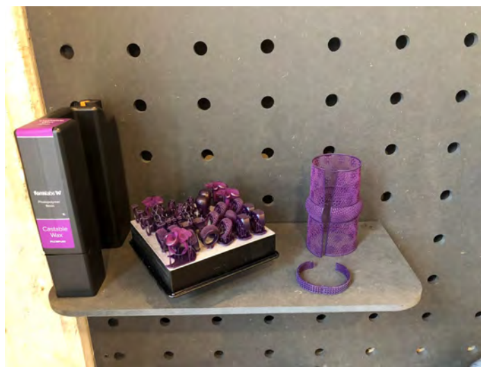
Slika 17 Primjer SLA tehnologije u proizvodnji nakita
