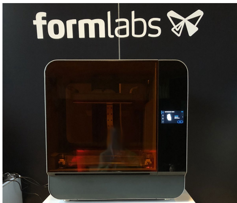
Slika 21 Uređaj za stereolitografsku aditivnu proizvodnju - Formlabs Form 3
