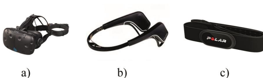
Slika 40: Oprema korištena u istraživanju a) HTC Vive, b) Muse EEG c) Polar H10 prsna traka
