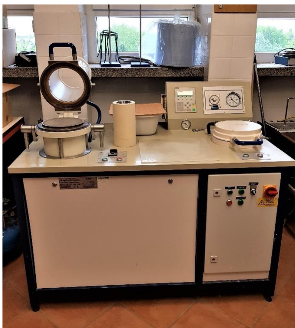
Slika 10. Laboratorijski uređaj za izradu papira Rapid Köthen.
