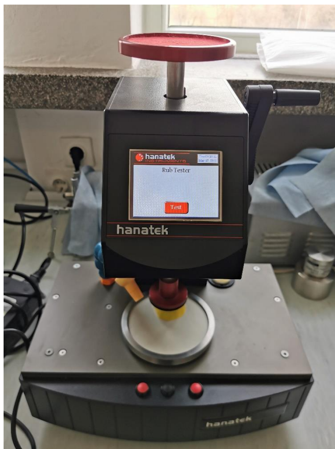
Slika 25. Laboratorijski uređaj Hanatek RT4 Rub and Abrasion Tester.
